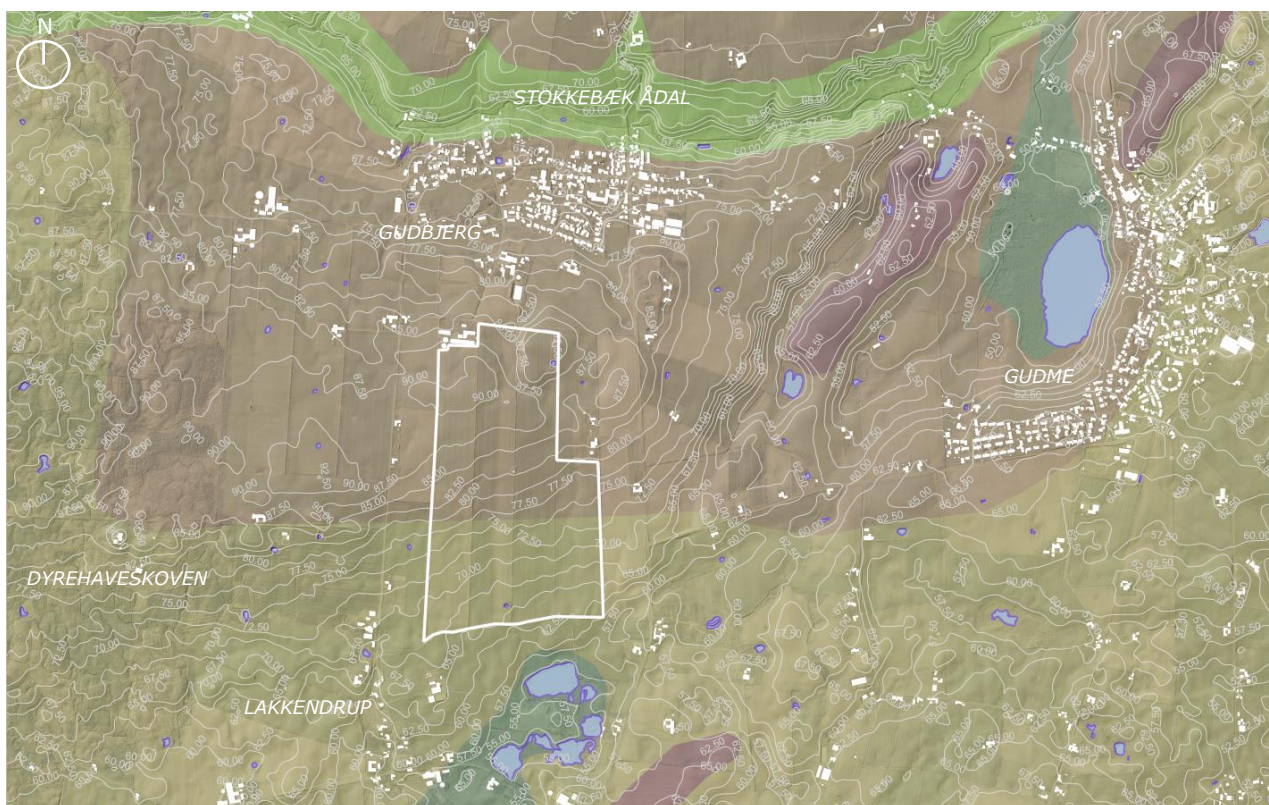
Figur 6: Geomorfologiske forhold, hydrologi og terræn indenfor plan- og projektområdet (hvid streg). Landskabet består delvist af en bundmoræneflade (brun) og dødislandskab (gul). Mod nord er der en erosionsdal (lys grøn). Plan- og projektområdet er beliggende på en bakke mellem Lakkendrup og Gudbjerg og falder mod syd. Bebyggelsen kan på figuren ses (hvid farve)
